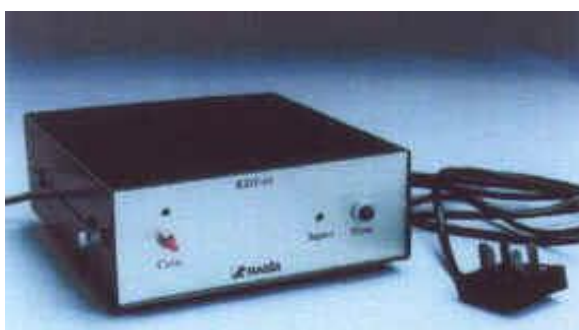
Сурет 2.4 – RDT-01 жоғары вольтті импульстерінің генераторы
